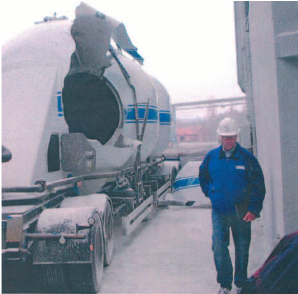
Svåra olyckor har inträffat när oreducerad fabriksluft använts för att förstärka luftkapaciteten till exempel vid långa lossningsledningar. För högt tryck, 5 bar, har gått in bakvägen i tryckkärlet.
